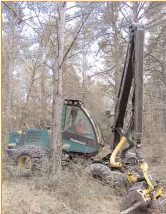
*La tête d'abattage est montée sur un bras télescopique. Orientable en tout sens, elle sectionne la tige, l'ébranche, la tronçonne en rondins dont elle mesure les dimensions.*
