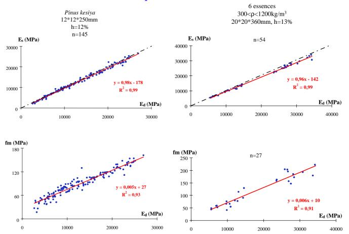
E<sub>s</sub> est le module d'élasticité statique obtenu par un essai normalisé (norme française ou européenne pour les pièces en dimension d'emploi).
