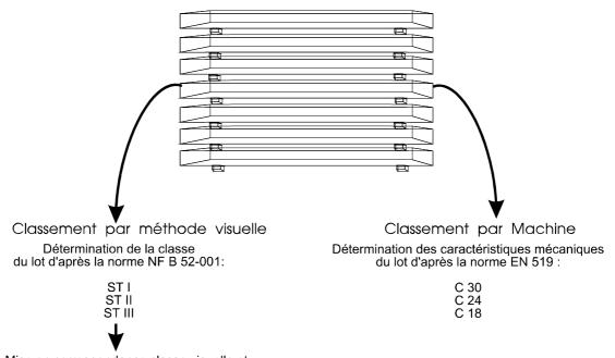
Mise en correspondance classe visuelle et classe de résistance mécanique d'aprés la norme NF EN 1912 :
