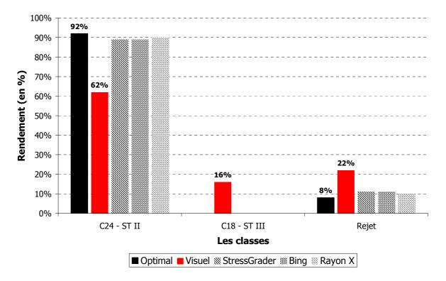
Si les exigences du marché ne portent que sur les deux classes de résistances les plus basses du classement structure (C24 – ST II ou C18 – ST III) le classement machine reste le plus intéressant en terme de valorisation des produits de sciage. Cependant, le classement visuel peut être intéressant d'un point de vue économique étant donné l'investissement que représente une machine de classement.
