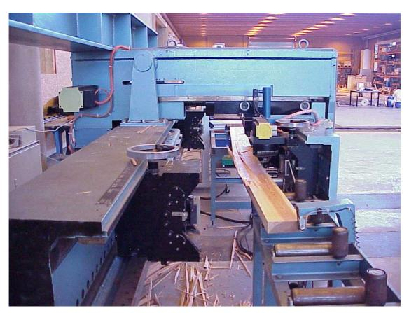
Banc de flexion du CTBA de Bordeaux où les avivés sont sollicités à chant, dans le cas d'une utilisation structurelle, afin de déterminer la contrainte à la rupture et le module d'élasticité
