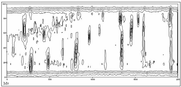
Exemple de variation de masse volumique d'une poutre de 40\*100\*2000 mm.
