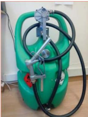
L'ONF 84 et la cellule BD 13 nous signalent l'existence de matériel facilitant le ravitaillement des torches. Il s'agit d'une cuve de 55 litres avec pistolet de remplissage. Le réservoir et les joints sont prévus pour résister à l'essence et au gasoil. Prix 479 € ttc.
